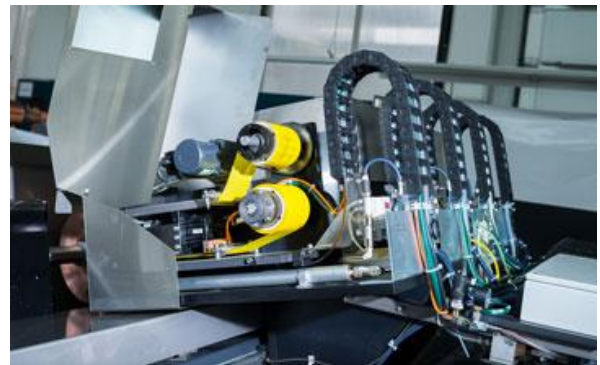
Poliereinheiten mit innovativem Klappmechanismus
