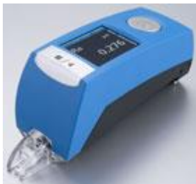
DG Rz-Star zur mobilen Rauheitsmessung
