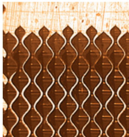
Fehlerbild auf der Zylinderoberfläche: Prellen
