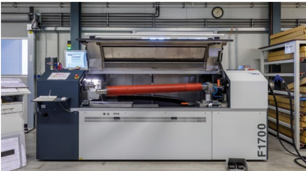
Der neue PremiumSetter F1700 mit 32 Laserdioden für die Bebilderung fotopolymere Flexodruckplatten wurde bei Flex-Punkt im Sommer 2019 installiert und nach eingehender Prüfung im Frühjahr 2020 abgenommen
